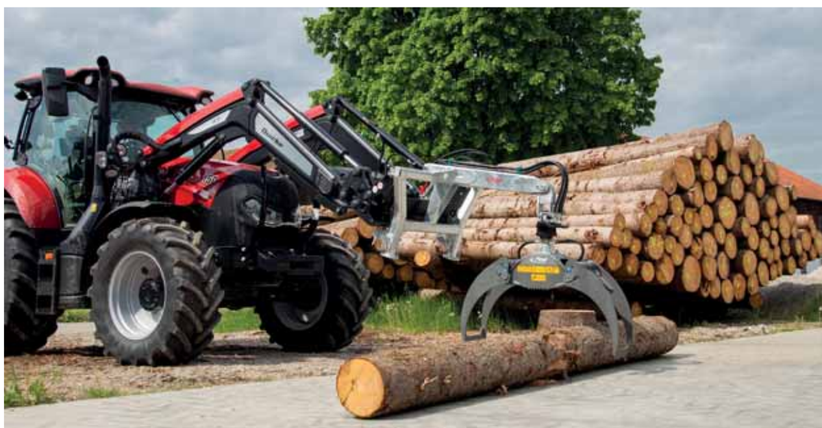
Koormakonsu pikendusega, pöördmootori, Euronormi ja kolmpunkt-kinnitusega laadimishaarats
