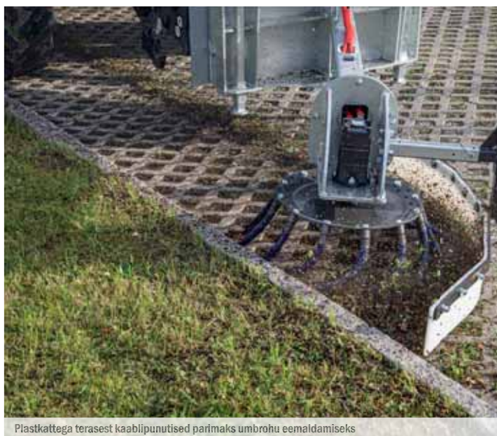
Plastkattega terasest kaablipunutised parimaks umbrohu eemaldamiseks
