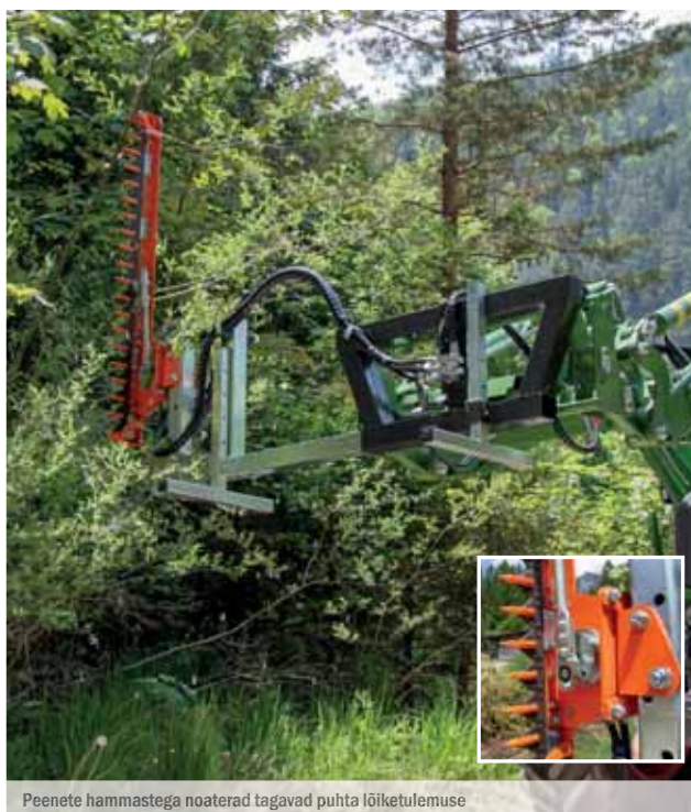
Peenete hammastega noaterad tagavad puhta lõiketulemuse
