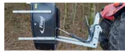
2 silindrit optimaalse 111° kaldenurga jaoks
