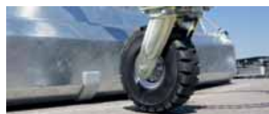
Tugirattad raske koorma jaoks Ø 306 mm – ülielastsed Täiskummist rehvid, laius 105 mm, kuullaagrid, kulumiskindel turvis, vastupidav pöödrõngas, reguleerita spindel
