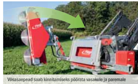
Võsasaapead saab kinnitamiseks pöörata vasakule ja paremale
