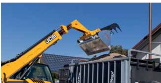
Piigid on valmistatud väga kulumiskindlast HB 500 terasest (paksus 20 mm)
