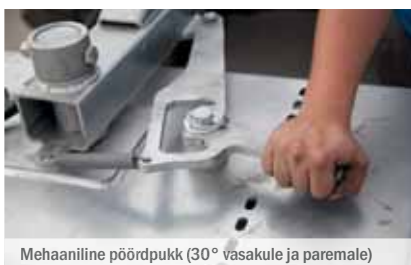
Mehaaniline pöördpukk (30° vasakule ja paremale)
