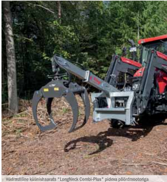
Hüdrauliline küünishaarats "LongNeck Combi-Plus" pideva pöördmootoriga
