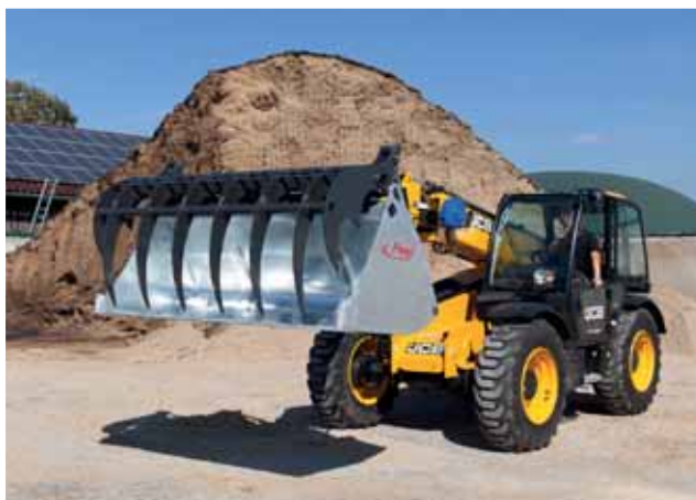
Piigid on valmistatud väga kulumiskindlast HB 500 terasest (paksus 20 mm)
