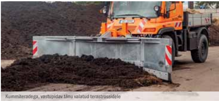
Kummiteradega, vastupidav tänu valatud terastrossidele
