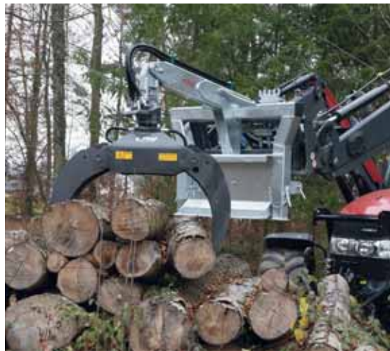
Hüdrauliline küünishaarats "RZ 185 Combi-Plus" virmastamisteraga (valikuline)
