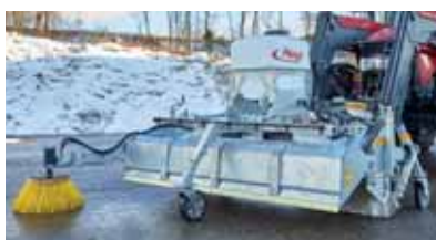
Kolmpunkt-kinnituse, hüdraulilise prügimahuti, külgharja ja tugiratastega
