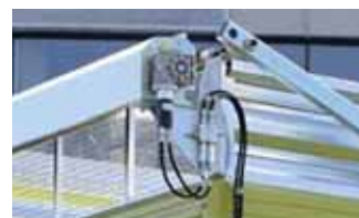
Hüdrauliline käitamine ölimootori abil – võrgu sissetõmbamiseks
