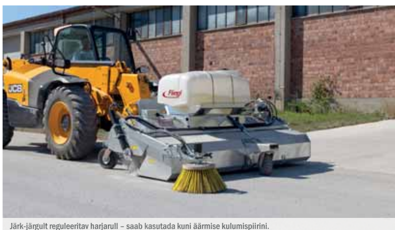
Järk-järgult reguleeritav harjarull – saab kasutada kuni äärmise kulumispiirini.
