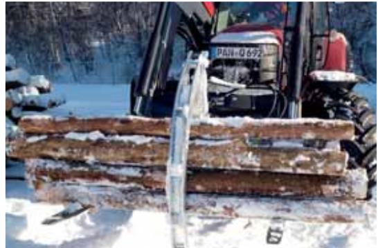
Hüdrauliline haarats, mis on kinnitatud kombineeritud tõstekahvile "Freisicht"
