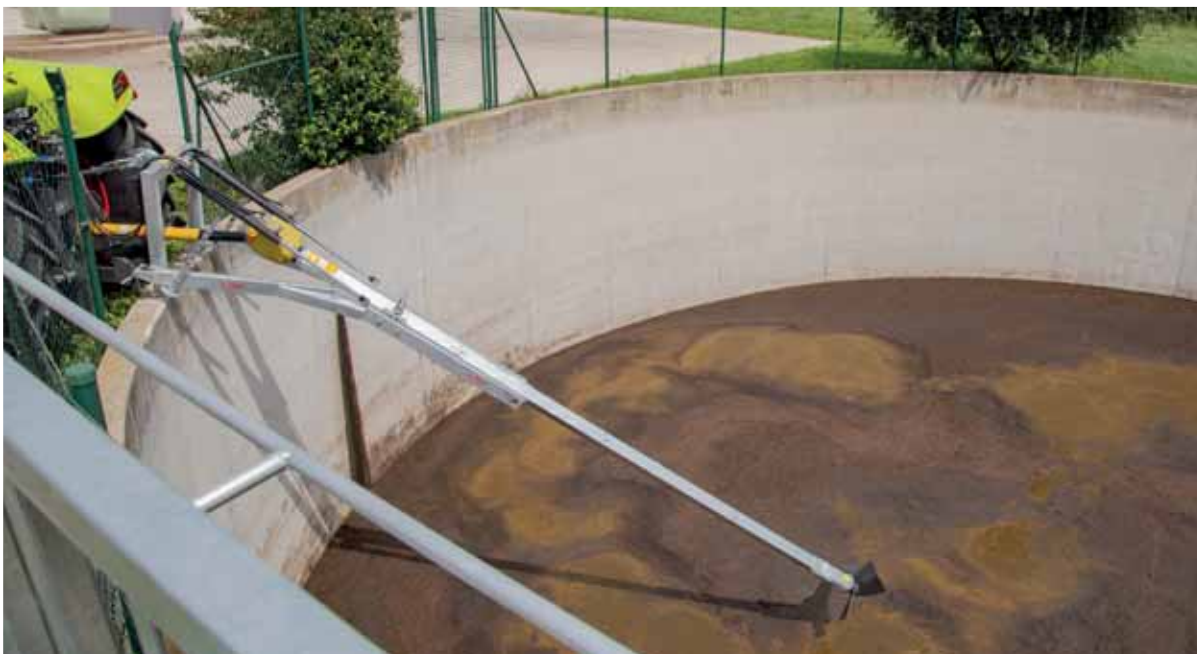
Hüdrauliselt kokkuklapitav – saab kasutada sügavates süvendites
