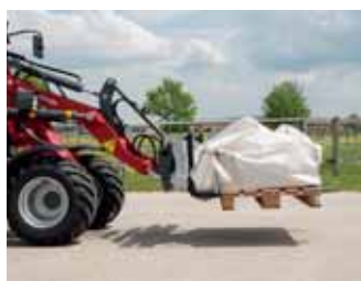
3 Kaitsepiire (valikuline), mis kaitseb libisemise eest, nt puidu, pallide, terasprofiilide jms vinnastamisel – saab kiiresti ja lihtsalt tagantjärele paigaldada
