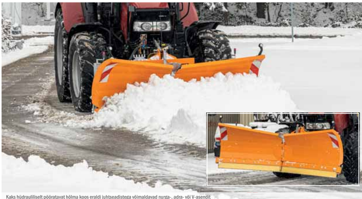
Kaks hüdrauliliselt pööratavat hõlma koos eraldi juhtseadistega võimaldavad nurga-, adra- või V-sendit
