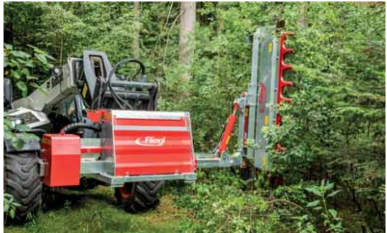
Noalatt on valmistatud väga kulumiskindlast terasest HB 500
