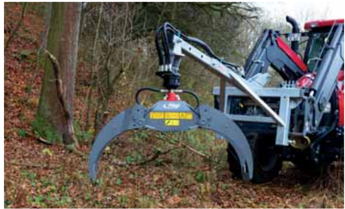
Koormakonksu pikendusega, pöördmootori, Euronormi ja kolmpunkt-kinnitusega laadimishaarats
