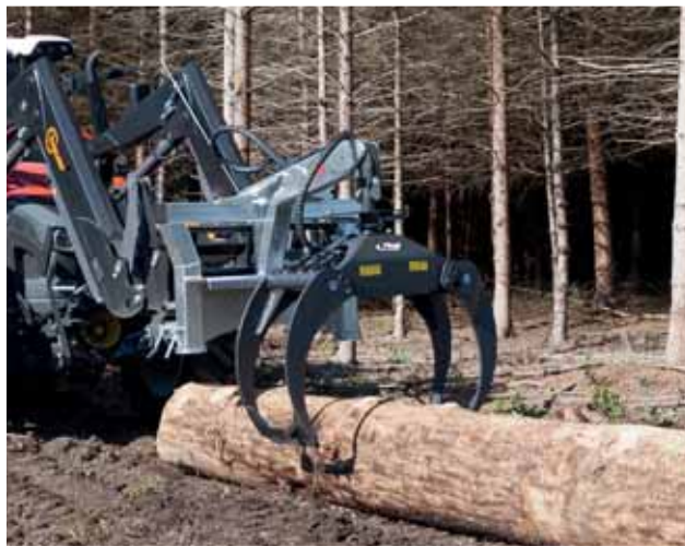
Hüdrauliline küünishaarats "RZ 185 Combi" mehaanilise pöördliigendiga
