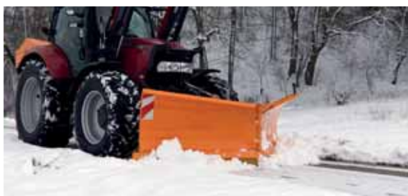
Sahk on parima korrosioonikaitse tagamiseks tsingitud ja täiendavalt värvitud
