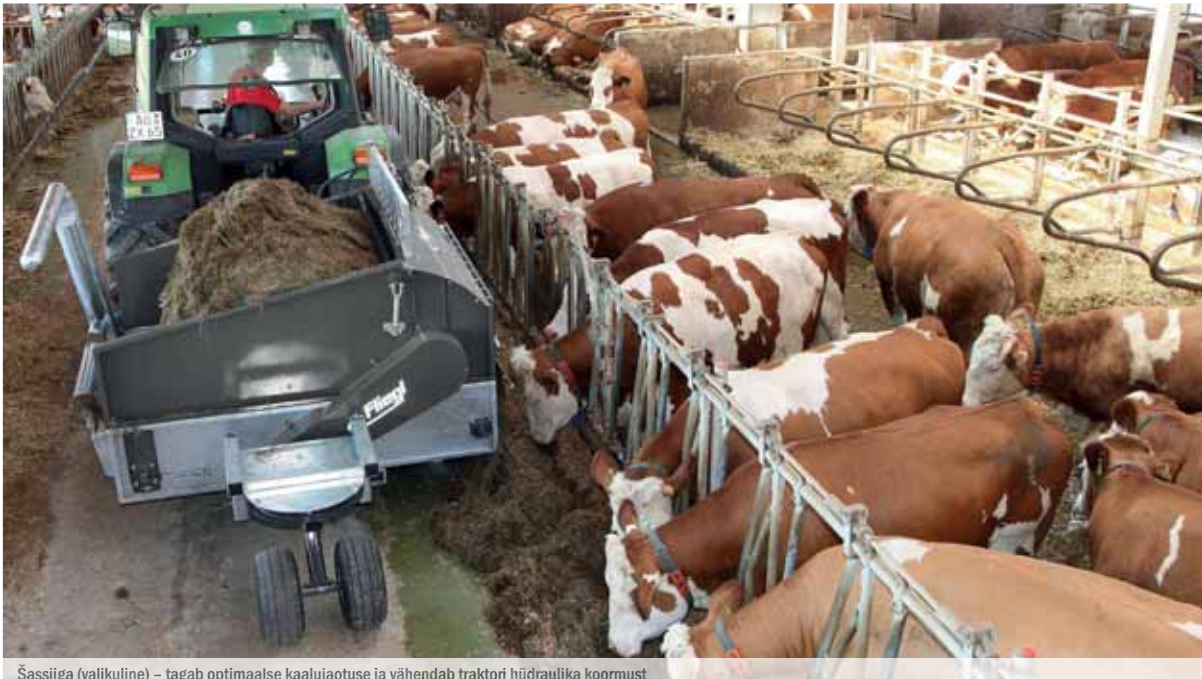
Šassiiga (valikuline) – tagab optimaalse kaalujaotuse ja vähendab traktori hüdraulika koormust
