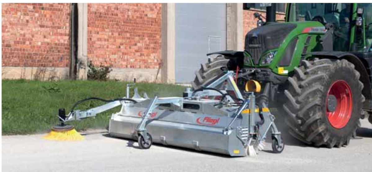
Kolmpunkt-kinnituse, hüdraulilise prügimahuti, külgharja ja tugiratastega
