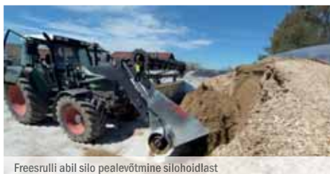
Freesrulli abil silo pealevõtmine silohoidlast
