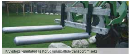
Kruvidega kinnitatud lisatorud ümarballide transportimiseks
