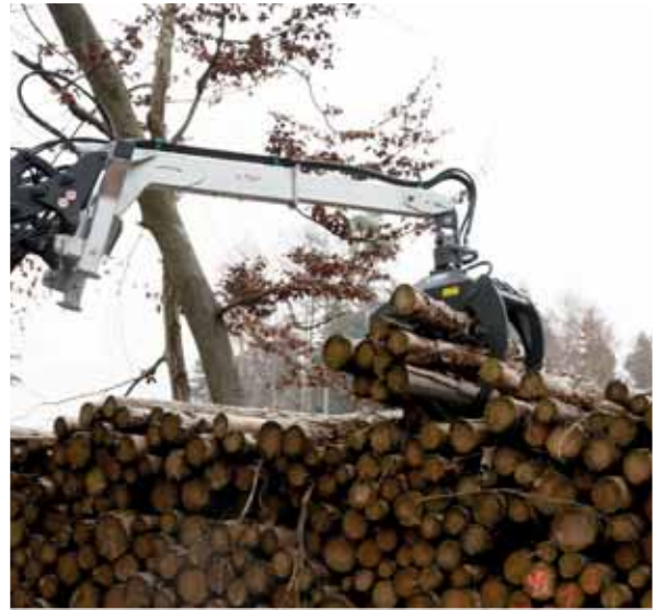
Hüdraulilised küünishaarats "LongNeck Combi-Plus" koos pideva pöördmootoriga
